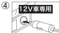
自動車のシガーソケットに、電源ケーブルのシガープラグを奥までしっかりと差し込みます。
