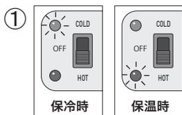
スイッチを「COLD(保冷)」もしくは「HOT(保温)」に設定します。
